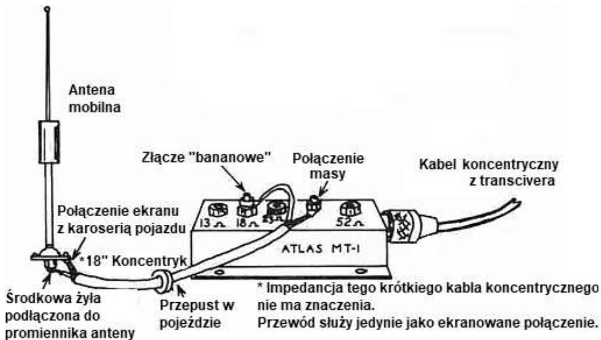
Rysunek 5-4. Instalacja transformatora MT-1
