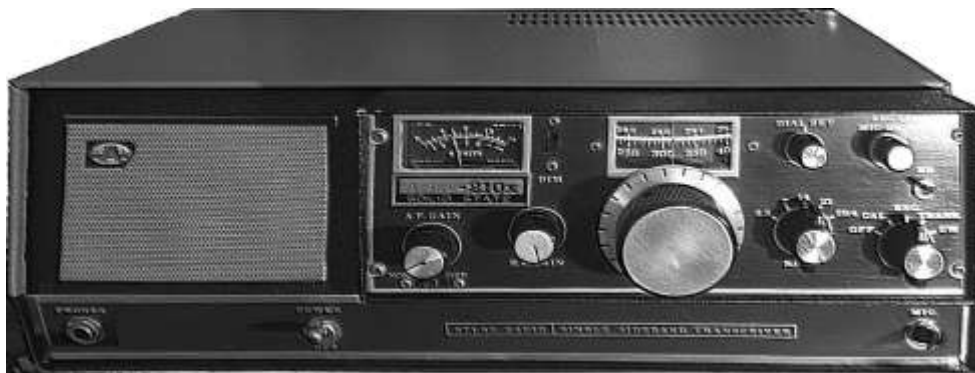
Rysunek 1-1. Model Atlas 210x przedstawiony z opcjonalną konsolą AC 220-CS
